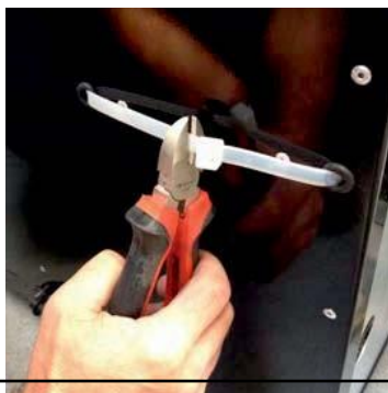
Obr. 2: Přeřízněte pásku vhodným nástrojem.
