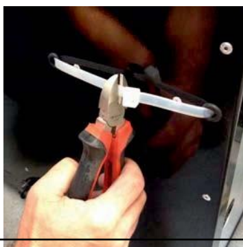
Obr. 2: Přeřízněte pásku vhodným nástrojem.
