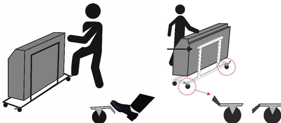
Obr.1 Po přesunutí odvlhčovače na mobilním stojanu na místo instalace, zajistěte brzdu kol. Brzda kol je zajištěna, když je páčka brzdy dolů. Brzda kol je odjištěna, když páčka je nahoře.
